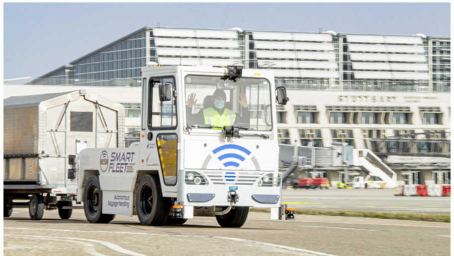
Hightech aus und für Baden-Württemberg: Gemeinsam mit den Entwicklern des selbstfahrenden Gepäckschleppers testet der Flughafen dessen Einsatz auf dem Vorfeld. Das Bundesministerium für Wirtschaft und Energie fördert das Projekt.
