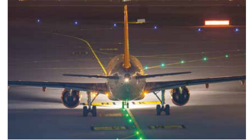
↑ Um weniger Energie zu verbrauchen, ist die Umstellung auf LED-Leuchten ein wichtiger Hebel – nicht nur auf dem Dach, sondern auch auf der Runway, den Rollwegen und dem Vorfeld.
