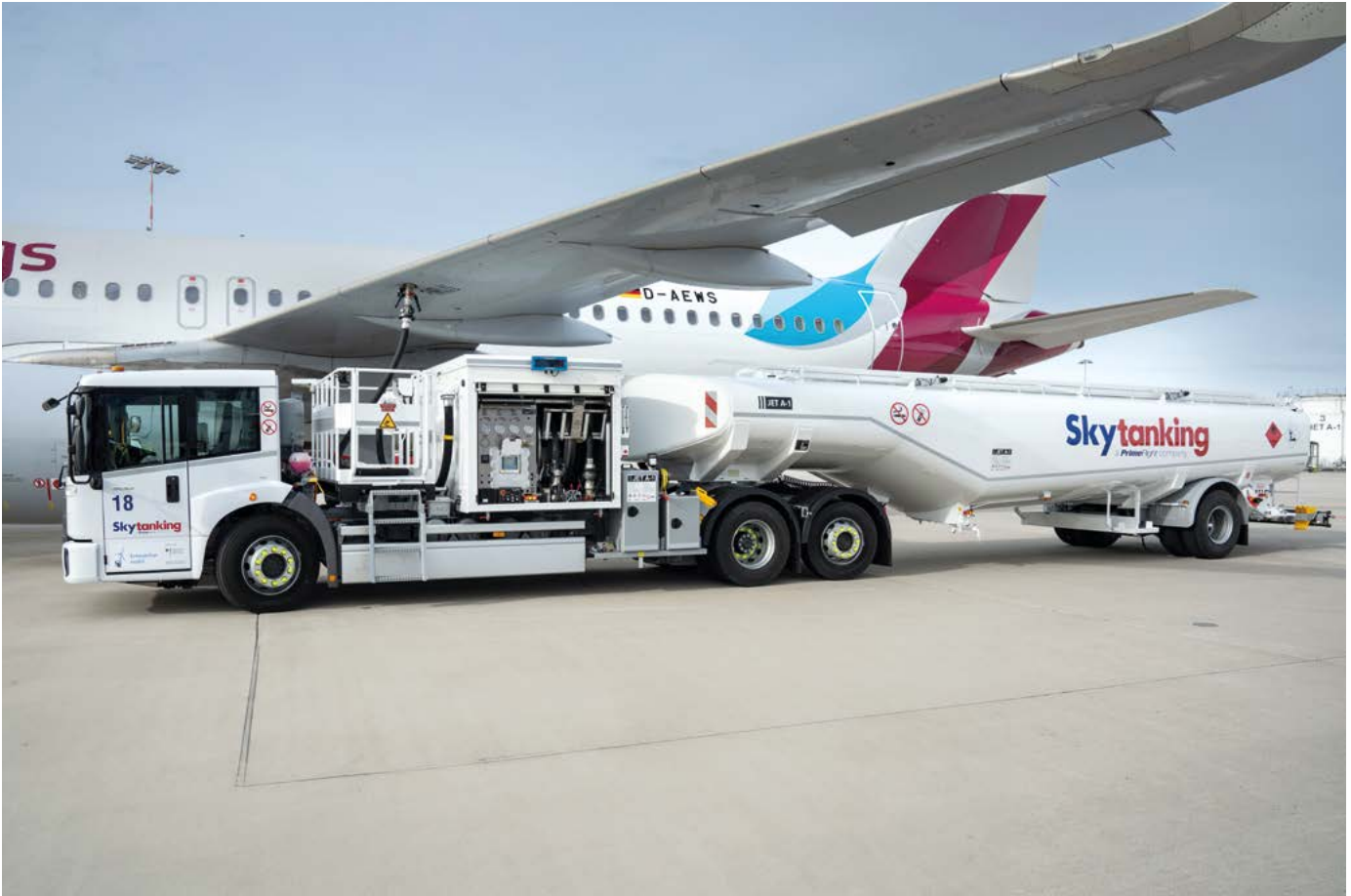
Ein elektrischer Tankwagen ist beim Fahren und Befüllen von Flugzeugen viel leiser. Damit es auf dem Vorfeld ruhiger wird, haben sich der Flughafen, Skytanking und das Institut für Stromrichter-technik und Elektrische Antriebe (ISEA) der RWTH Aachen in einem Forschungsprojekt zusammengetan. Darin befassen sie sich mit schweren E-Nutzfahrzeugen wie diesem 52-Tonner.
