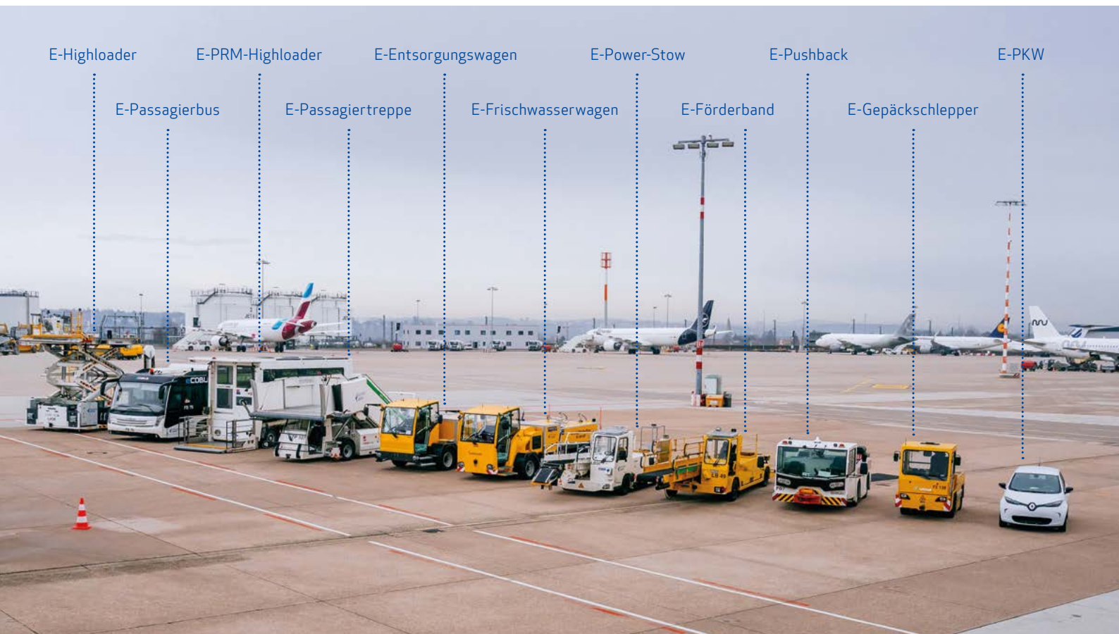
Von klein bis groß: Die Elektro-Flotte am STR wächst um immer mehr verschiedene Fahrzeugtypen. Insgesamt sind über 110 batteriebetriebene Fahrzeuge auf dem Vorfeld unterwegs.
