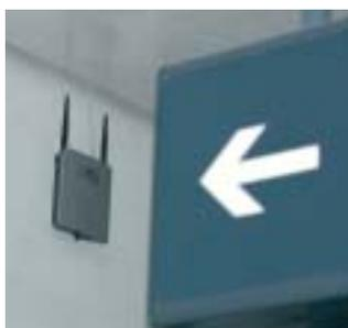
Sender an den Terminalwänden leuchten die WLAN-Zonen aus
