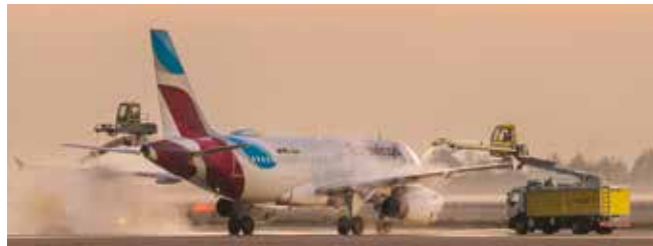
↑ Unter die Brause: Die Dusche vor der Arbeit macht die Flieger fit für die Reise. Aus schweren Flügeln werden wieder aerodynamische Tragflächen.
